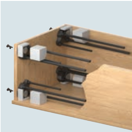
圖1：定位螺栓和槽模的組裝
