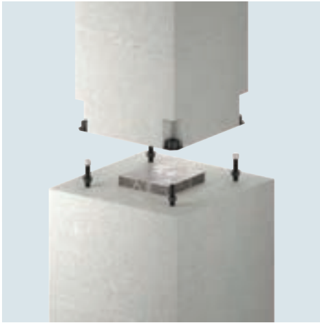
圖3: 鋼製墊片、底部螺帽、墊圈、保護蓋定位示意圖。
