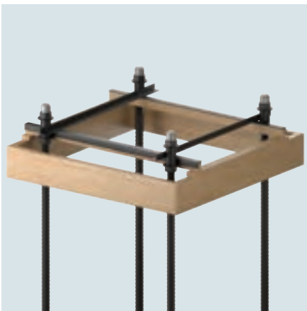
圖2：定位螺栓和槽模的組裝
